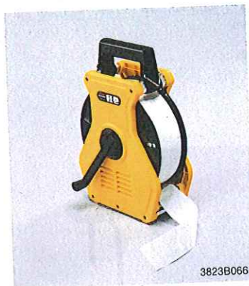
3823B066 フィールド用ラインテープ透過式(白) ケース付き (個)¥66,000 (税抜価格 ¥60,000) 1 サイズ: ケース/(W) 230×(L) 125×(H) 345mm テープ/(W) 50mm×(L) 100m (T) 0.3mm 重量: 約2.25kg 材質: ケース/ABS樹脂、テープ/ナイロン
