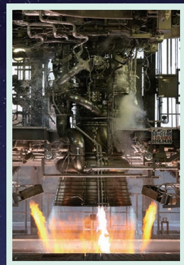
▲LE-9エンジン燃焼試験の様子(種子島宇宙センター)
